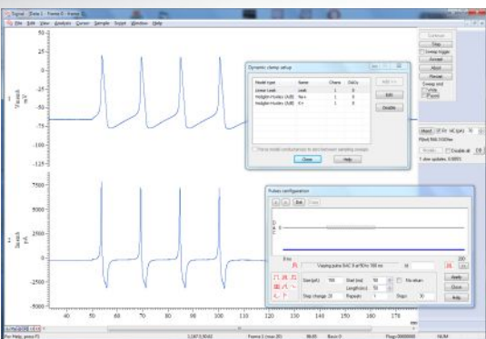
Verrouillage dynamique simulant des potentiels d'action, avec accès aux paramètres du modèle en cours d'échantillonnage
