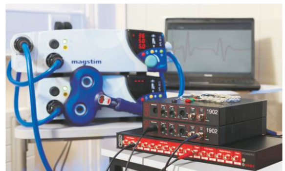
MEP sistema de gravação
