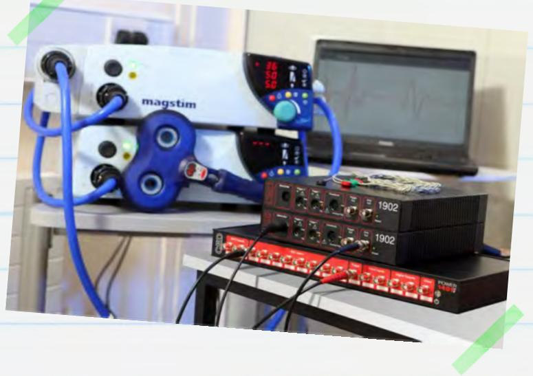
*Signal* 是一个基于扫描的数据捕捉和分析软件包。它可以在采样过程中直接控制Magstim刺激器的参数，包括调整刺激强度和触发时序。本手册可以帮你用*Signal*，一个1401接口和一个1902放大器和一个Magstim刺激器建立一个TMS系统，用于记录诱发电位。
