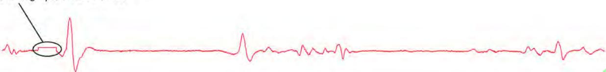
Los artefactos de estímulo pueden a menudo saturar la entrada de un amplificador, causando un período de grabación 'perdida' mientras la entrada del amplificador vuelve al nivel normal. Esto puede ocasionar problemas si la respuesta es muy rápida o se está registrando cerca del lugar de estimulación. El diagrama anterior muestra una respuesta MEP rápida desde el electrodo (Fig. A) que se ha perdido debido a la saturación del amplificador causada por el artefacto del estímulo (Fig. B).
