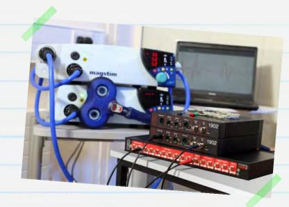
Signal是一個基于掃描的數據捕捉和分析軟件包。它可以在采樣過程中直接控制Magstim刺激器的參數,包括調整刺激强度和觸發時序。本手冊可以幫你用Signal,一個1401接口和一個1902放大器和一個Magstim刺激器建立一個TMS系統,用于記錄誘發電位。
